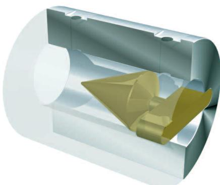
Новое межфланцевое тело обтекания Wafer-Cone можно смонтировать между двумя фланцами, что позволяет добиться более компактного расположения. Он изготавливается из различных материалов, и конус можно легко заменить в зависимости от изменения характеристик потока.
