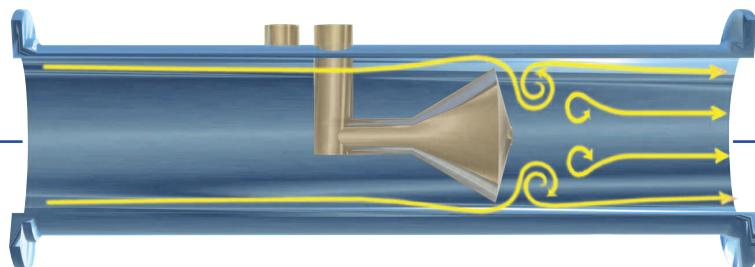
Профилированный конус тела обтекания V-cone отводит поток вихрей от линии излома тела обтекания. В результате бета-кромка конуса не подвергается износу загрязненными жидкостями. Благодаря неизменности конуса расходомерам V-Cone очень редко требуется повторная калибровка, или повторная калибровка может вообще не потребоваться.
