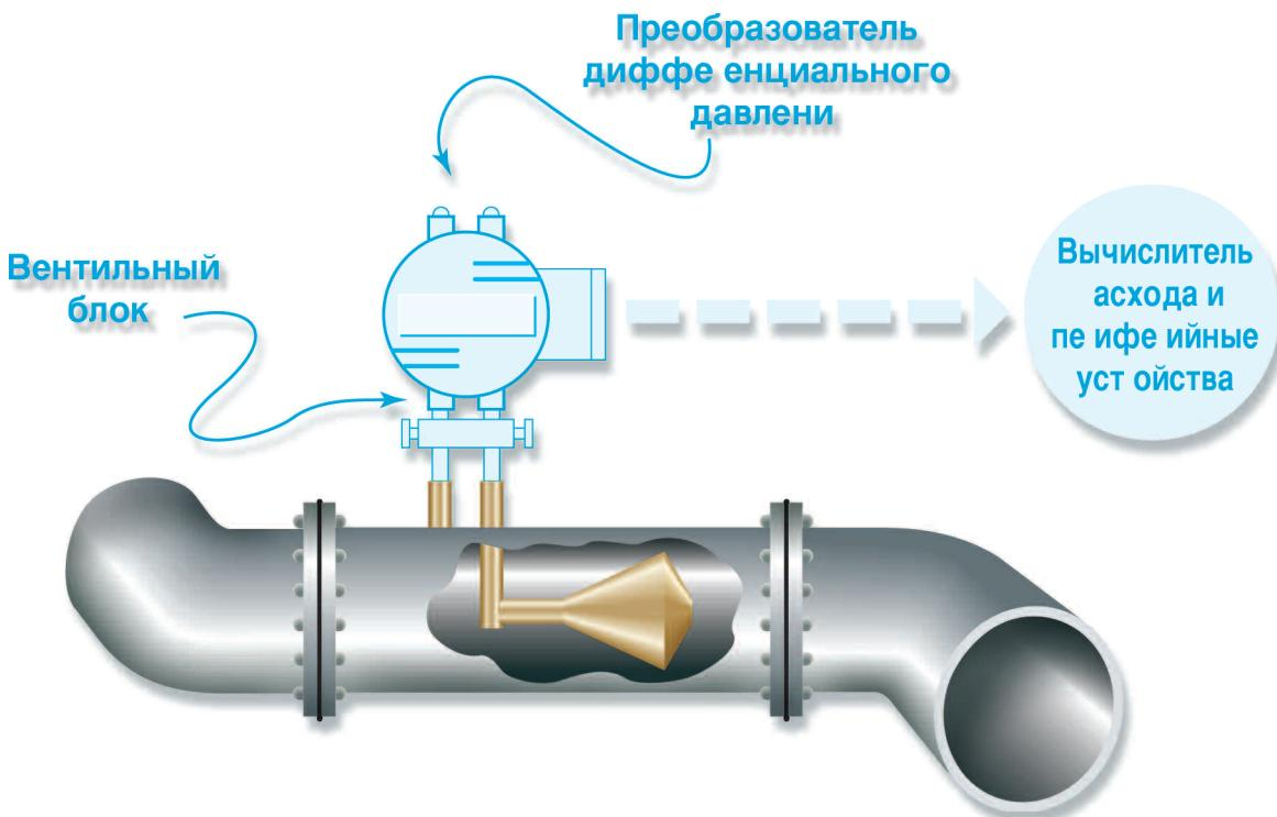
**Стандартная точность:** До  $\pm 0,5\%$  текущего расхода (для определенных жидкостей и отдельных значений числа Рейнольдса требуются специальные калибровки, чтобы достичь этого значения).
